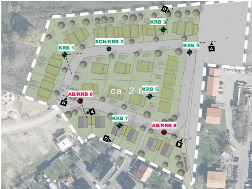
Abb. 3 Verortung der 8 durchgeführten Kleinrammbohrungen innerhalb des geplanten Baugebietes
