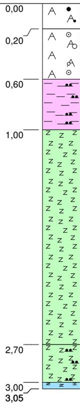
Kies; sandig, schwach schluffig, Auffüllung, grau, erdflecht, mäßig schwer zu bohren, Schlacke-Mineralgemisch
